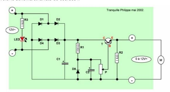
T : 1 transistor TIP 112 (avec son dissipateur)
