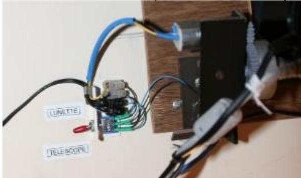
Un petit montage avec un double inverseur me permet de sélectionner la mise au point soit du porte oculaire du télescope, soit celui de la lunette sans changer de logiciel et permet d'utiliser la même raquette de mise au point sans déconnecter l'un ou l'autre.
