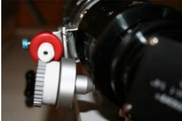
Un ressort de rappel maintient en tension le montage sur la roue dentée.
