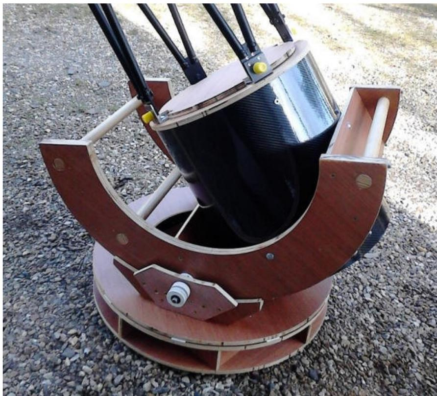
Les tourillons et la base tournante glissent sur des petites cales en pvc lubrifiées avec du silicone en aérosol ( rayon automobile des grandes surfaces de bricolage...) puis les champs en contreplaqué des tourillons ainsi que la surface de la base ont été enduits de paraffine ( rayon bocal à confiture et cave ). Le déplacement de l'ensemble glisse à la perfection !
