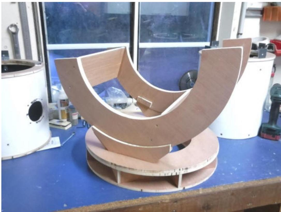
Voici les cercles de contreplaqué avec les équerres en aluminium ou viendront se positionner les tubes de serrurier.
