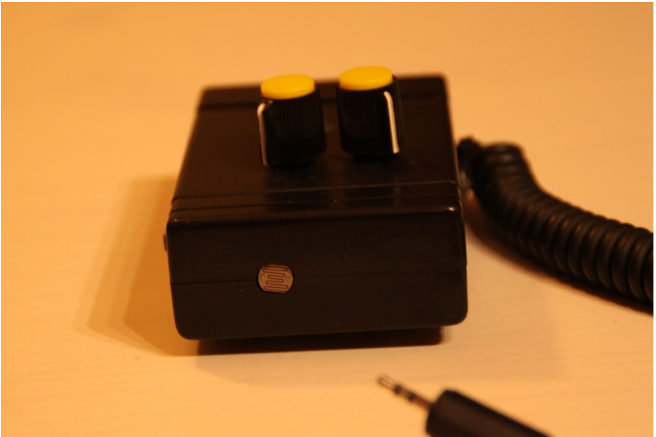
Vue de face, la photorésistance est logée en façade au ras du boîtier.
