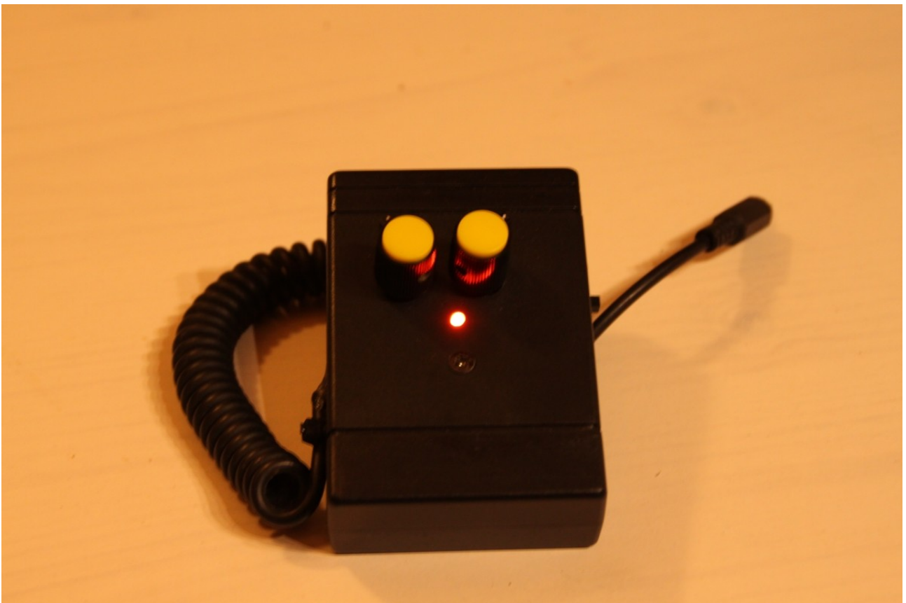
Vue de dessus, la LED est allumée, il faut ajuster les potentiomètres pour l'éteindre.
