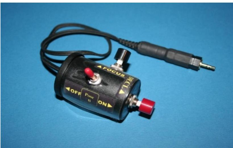
Tout est de la récup..., hormis l'adaptateur pour prise jack (3.5mm/2.5mm), 1.30 Euro, assuré par une gaine thermo-rétractable sur la prise jack 3.5mm de récupération (fil audio), afin d'éviter le risque d'une déconnexion intempestive.
